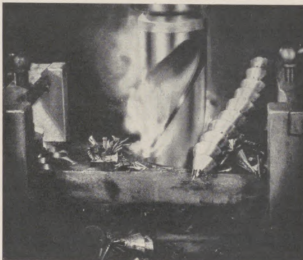
Bild 2: Bohren mit einem Hochleistungs-Spiralbohrer
