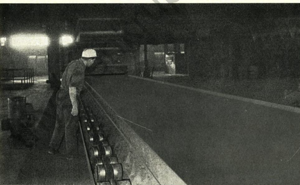
Der „Sinterkuchen“ wird von diesem Sinterband weiterbefördert. Im Hintergrund befindet sich die Sintermaschine mit der Mischfeuerungsanlage. — Bild rechts: In dem langen Anheiztunnel werden die ankommenden Eisenbahnwagen mit den Feinerzen bei Frostwetter aufgetaut, ehe sie in die Bunker gegeben werden. Diese Transporte führt der Gemeinschaftsbetrieb Eisenbahn und Häfen durch.
