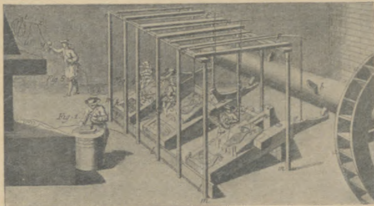
Abb. 7: Eisendrahtzieherei des achtzehnten Jahrhunderts (Nach einem zeitgen. Stiche)
