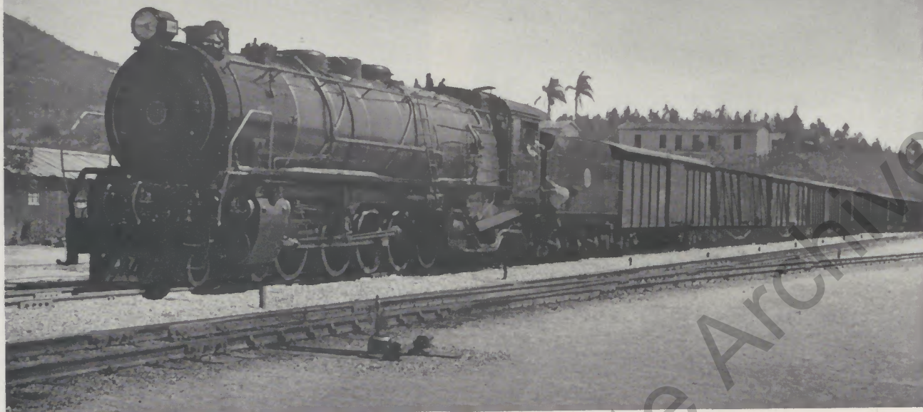
Eine 2 E 1 Henschel Güterzuglokomotive der Sorocabanabahn, Brasilien
