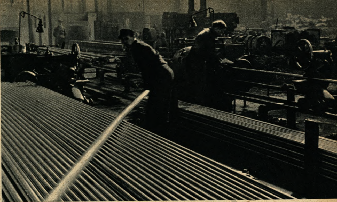
Mitte links: Auf diesen Ziehbanken werden Stäbe der verschiedensten Abmessungen und Güten gezogen.
