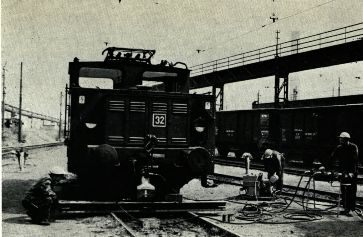
Abb. 1: Aufgleisen einer Lok mit dem „Lukas-Gerät“. In der Mitte unter der Pufferbohle ein öhydraulischer Heber auf Rollwagen. Der Rollwagen läßt sich auf der über den Schienen liegenden Gleisbrücke seitlich verfahren. Rechts davon das Pumpen-Aggregat zur Erzeugung des erforderlichen Öldruckes. Ganz rechts der Steuertisch zur zentralen Bedienung der Geräte.
