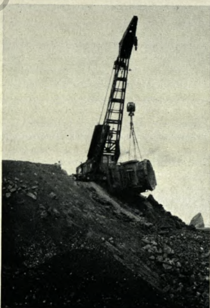
Abb. 7: Aufgleisen einer zweiachsigen Lok nach einer Entgleisung mittels Kran der Deutschen Bundesbahn, weil auf der Hochbahn keine Aufgleisgeräte angesetzt werden konnten.
