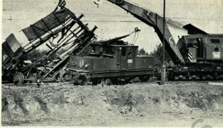
Abb. 5: Entfernung der Trümmer aus einer schweren Flankenfahrt mit dem 24-t-Kran von EH.
