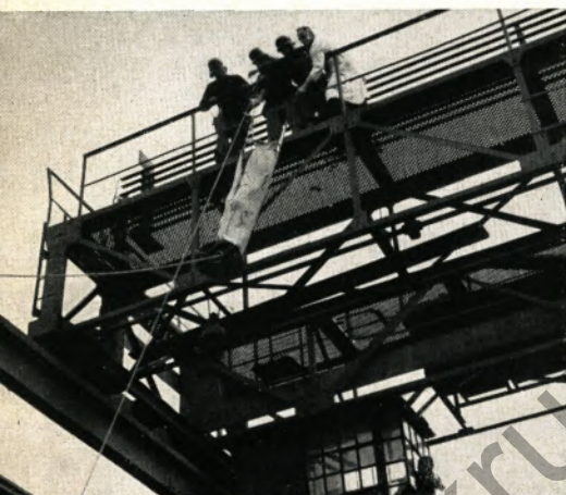
Vorsichtig wird die Höhentrage von der Kranbahn abgelassen. Der Verletzte ist vorher sehr sorgfältig eingeschnürt worden
