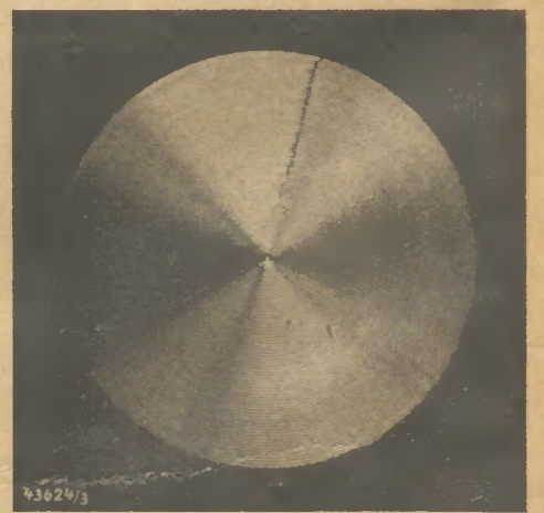
Abb. 9: Riß in einem gehärteten Stahl
