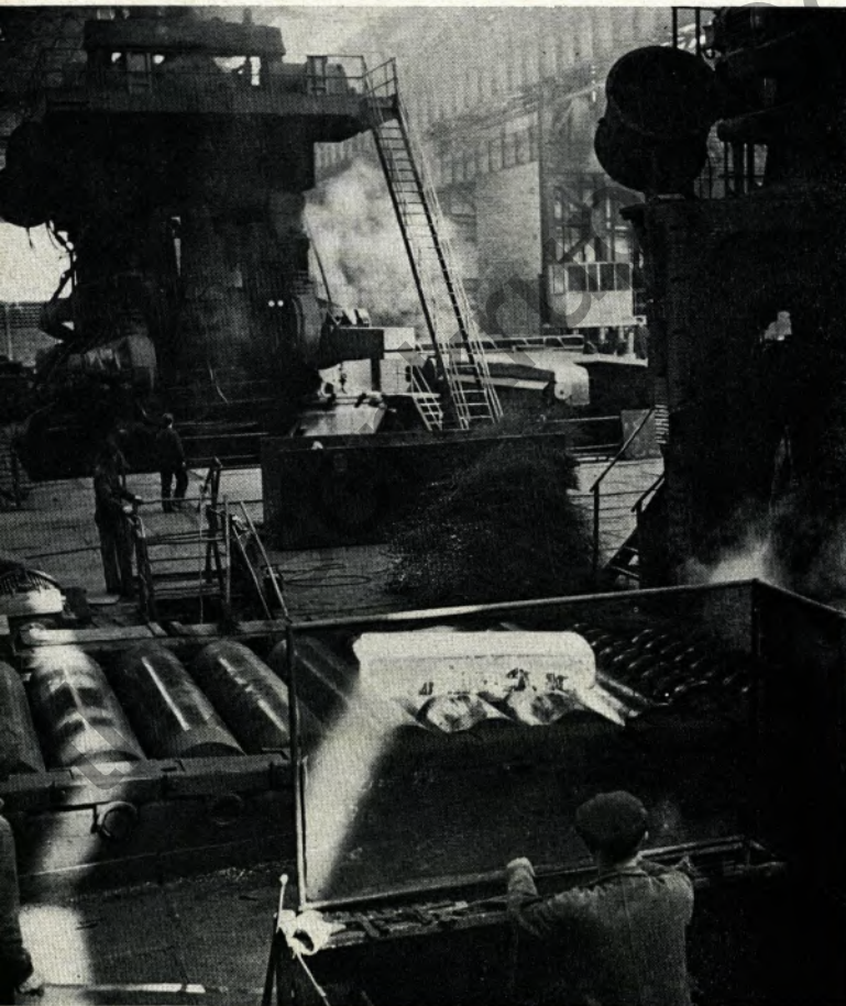
Auf der 3-Meter-Triostraße in Mülheim wird eine Bramme angewalzt. Im Hintergrund erkennt man Europas größte Grobblechstraße, die 4,8-Meter-Quartostraße
