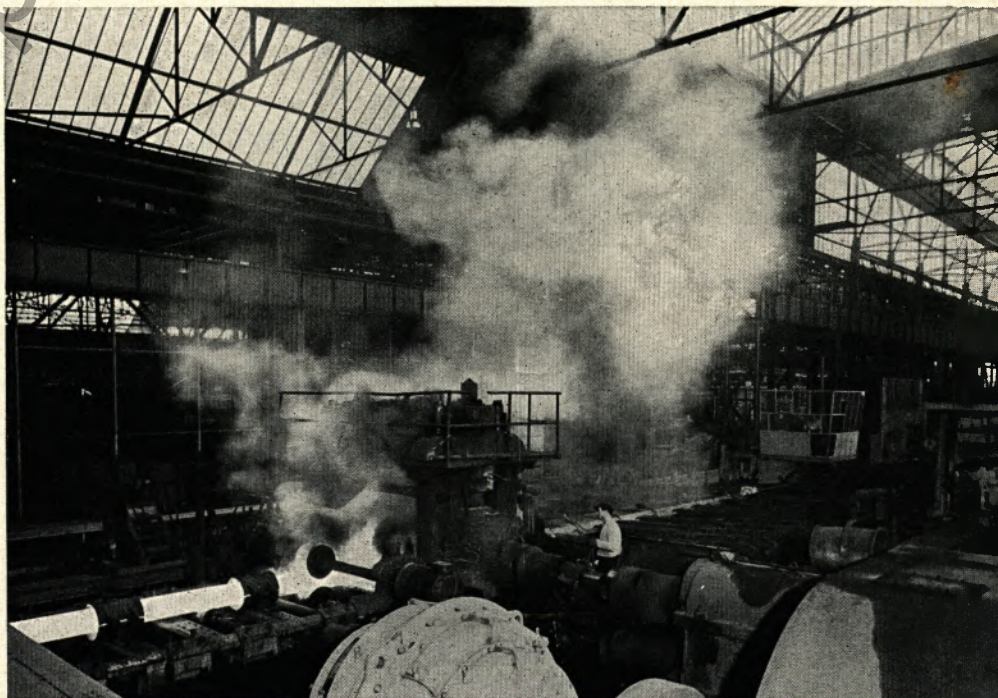
Dieses Bild vermittelt einen guten Einblick in die Stopfenstraße 4 des Werkes Poensgen. Die Anlage ist auf Rohre im Abmessungsbereich bis 10 Zoll und darunter, besonders auf Ölfeldrohre spezialisiert
