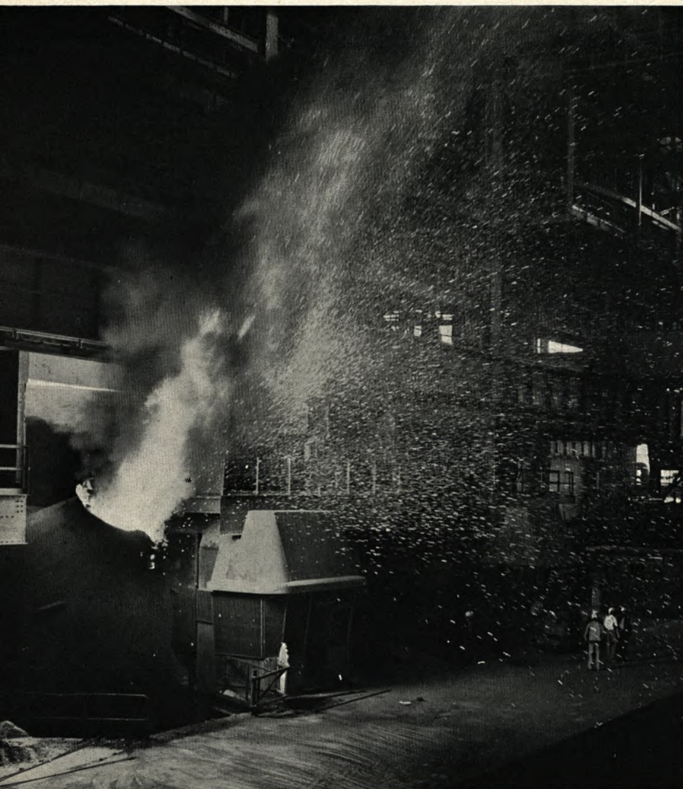
Bild oben: Der 70-Tonnen-Konverter wird hochgestellt und beginnt zu blasen. Für jeden ein faszinierender Anblick. Bild unten: Probeentnahme nach dem Blasen. Die Probe gibt Auskunft, ob die Charge gut geworden ist
