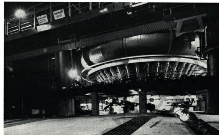
Blick auf eine der zwei Abstichbrücken für kontinuierlichen Roheisenabstich.
