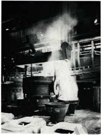
Unser Titelbild zeigt einen Abstich am 270-Tonnen SM-Ofen. Ganz oben die Traverse des Gießkranes mit 375 Tonnen Tragkraft, daran die Abstichpfanne (Bildmitte) und ganz vorn drei Kokillen.
