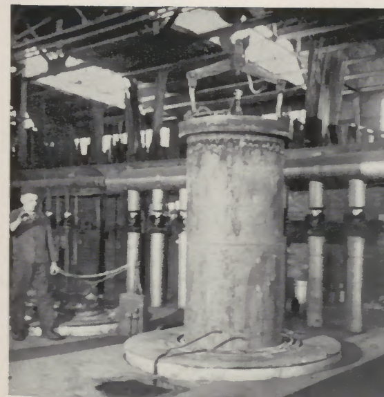
Erster Glüher Theodor Laufmanns beim Aussetzen eines Blankglühpfes aus einem Tiefofen.
