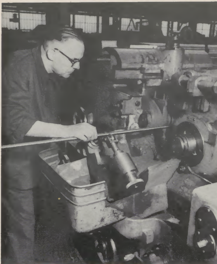
Schleifarbeiten an einer spitzenlosen Schleifmaschine
