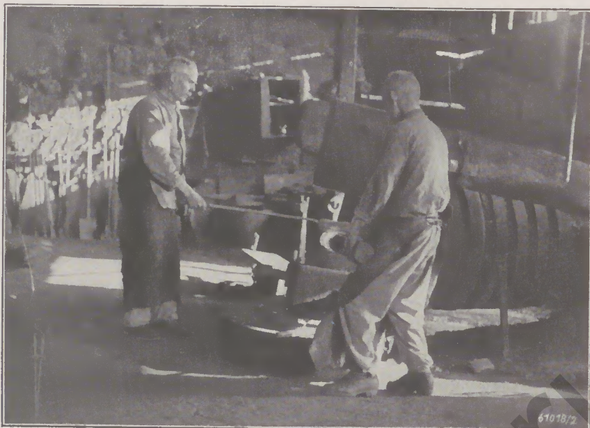
In der 250 Jahre alten Hammer-Schmiede Unter dem Hammer liegt ein Stück Rundern, von dem ein entsprechend langes Stück abgetrennt wird. Der alte Meister hält die Stahlstange, deren Ende zu einem Messer geformt ist, auf das Eisen. Rechts auf dem Bild die mit Eisenbändern umwickelte Antriebswelle
