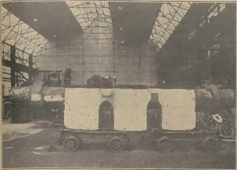
Rohgeschmiedete Welle vor dem Verdrehen in Gradstellung.
