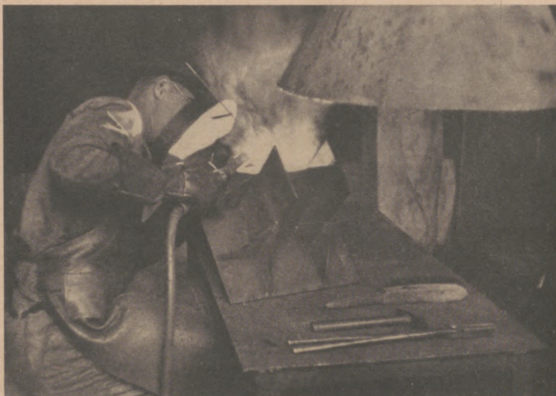
Schweißen eines Stützfußes (unproduktive Arbeit); Stahlbau Schlosserlehrling, zweites Lehrjahr
