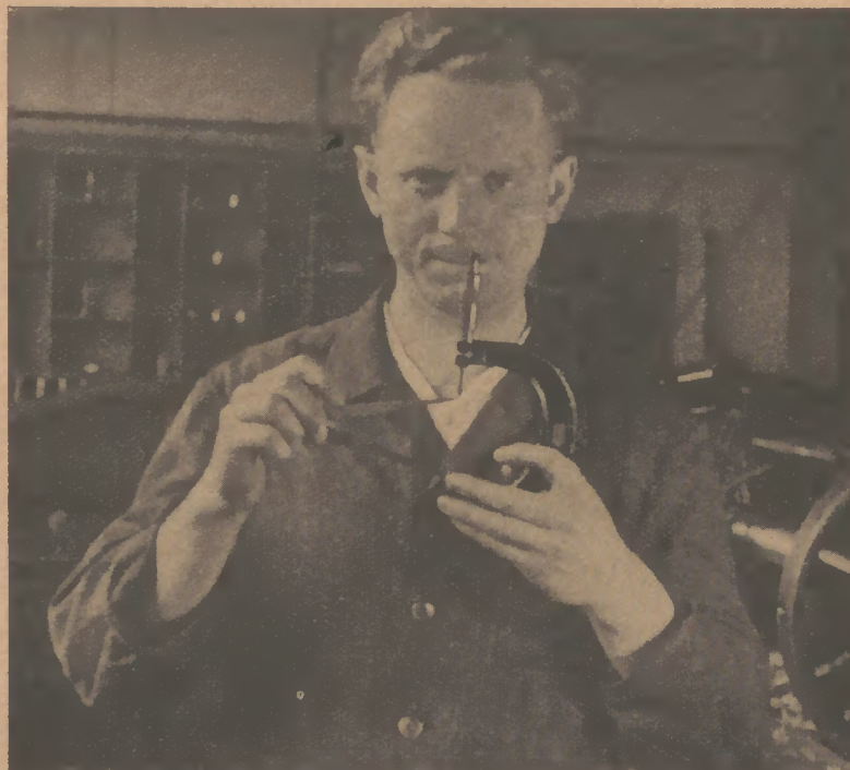
Einstellen des Lochtasters mit der Feinmeßschraube
