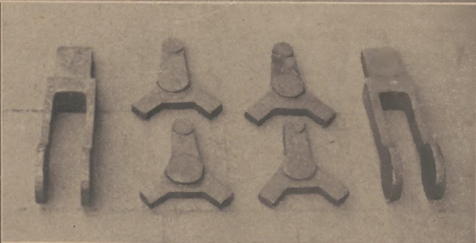
Formschmiedestücke auf Fertigmaß Links: Phosgasöfen für Werkzeuge
