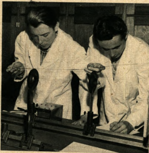
▲ Mit Hilfe der optischen Bank ermitteln Hermann Kunze und Horst Schlütermann die Brennweite von Linsen. Messen und saubere Protokollführung sind die Grundlagen jedes physikalischen Versuchs
