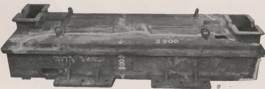
Abb. 71: Traversen nach Abb. 70. Fertig geschweißt
