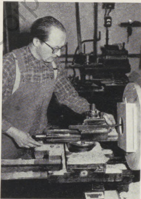
Bild 4 Reinhard Henkel beim Ausdrehen eines Kernkastens
