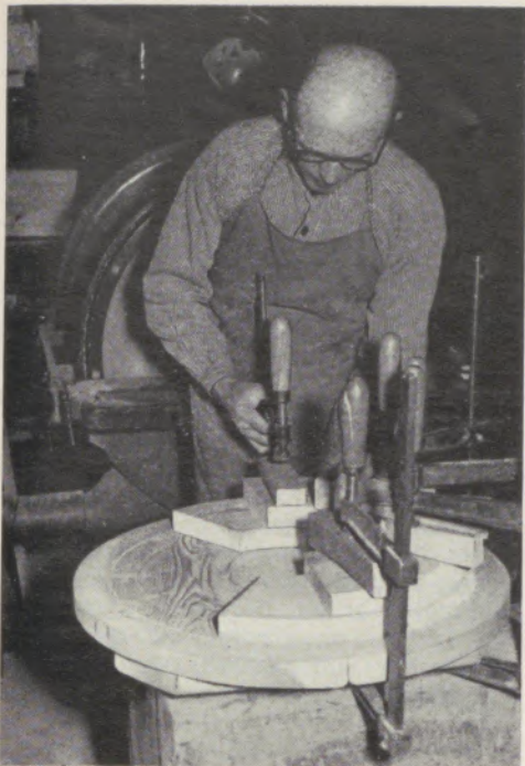
Bild 2 Paul Schmidt beim Verleimen eines Doppelbogenmodells
