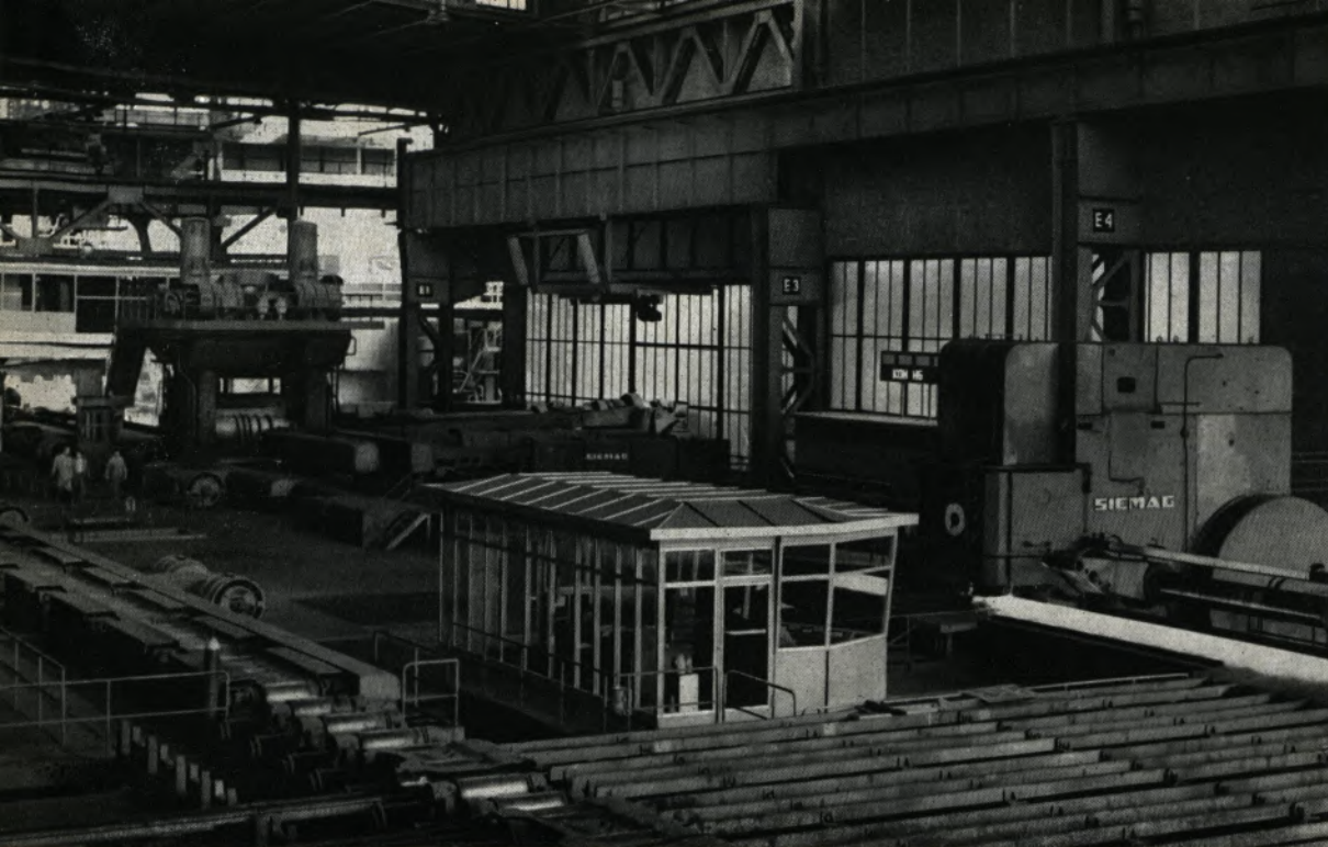
Ein Blick in die Blockhalle. Im Vordergrund der Querschlepper Q 1 mit dem Flämmrollgang, dahinter die Blockscheere mit der zugehörigen Steuerbühne, in der auch das Waagenpostament zur Anzeige der Blockgewichte aufgestellt ist. Die Verschiebevorrichtung zur Blockstraße ist in der Bildmitte zu erkennen, dahinter das Walzgerüst. Rechts im Bild die Abschlußwand zur Motorenhalle. Ein Block beim Anstich im ersten Gerüst der Staffel I. Die I. Staffel der Kontistraße hat zwei Vertikal- und zwei Horizontalgerüste. Links im Bild ist der Querschlepper Q 2 , der das Fertiggut der I. Staffel auf den Ablaufrollgang transportiert. Die Wand im Hintergrund schließt die Kontihalle von der Motorenhalle mit den Walzenzugmotoren ab. Im Vordergrund links ist der fahrbare Plattenbelag zu erkennen, der beim Walzen- oder Gerüstwechsel verfahren werden kann und somit die Ausfahreinrichtung freigibt. Ein eindrucksvolles Bild.
