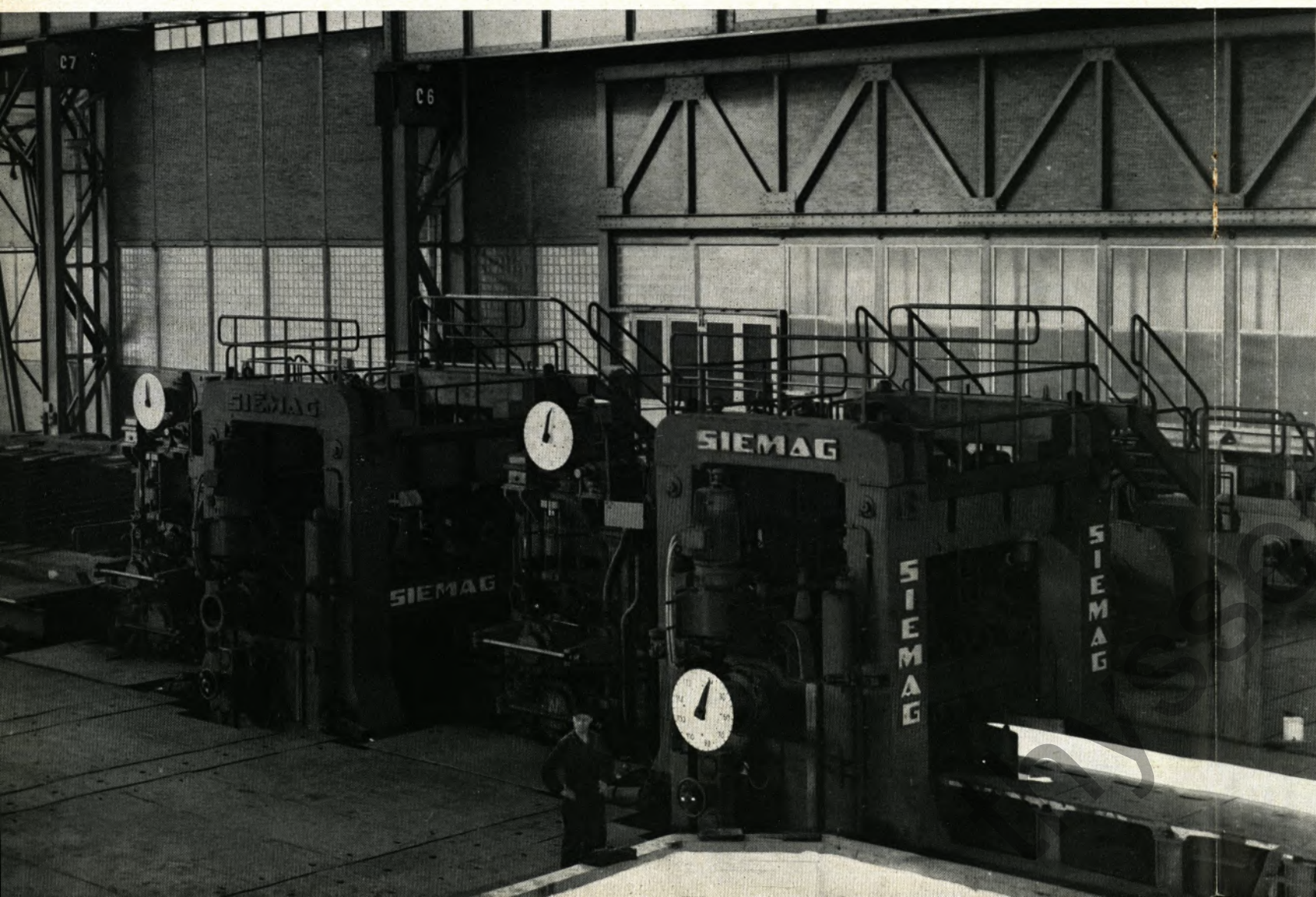
Ein Blick in die Blockhalle. Im Vordergrund der Querschlepper Q 1 mit dem Flämmrollgang, dahinter die Blockscheere mit der zugehörigen Steuerbühne, in der auch das Waagenpostament zur Anzeige der Blockgewichte aufgestellt ist. Die Verschiebevorrichtung zur Blockstraße ist in der Bildmitte zu erkennen, dahinter das Walzgerüst. Rechts im Bild die Abschlußwand zur Motorenhalle. Ein Block beim Anstich im ersten Gerüst der Staffel I. Die I. Staffel der Kontistraße hat zwei Vertikal- und zwei Horizontalgerüste. Links im Bild ist der Querschlepper Q 2 , der das Fertiggut der I. Staffel auf den Ablaufrollgang transportiert. Die Wand im Hintergrund schließt die Kontihalle von der Motorenhalle mit den Walzenzugmotoren ab. Im Vordergrund links ist der fahrbare Plattenbelag zu erkennen, der beim Walzen- oder Gerüstwechsel verfahren werden kann und somit die Ausfahreinrichtung freigibt. Ein eindrucksvolles Bild.
