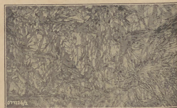
Abb. 10: 1,3 Prozent C überhitzt gehärtet
