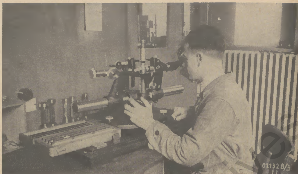
Prüfen eines Lechdorns mittels Optimeter, Meßgenauigkeit: 0,001 Millimeter
