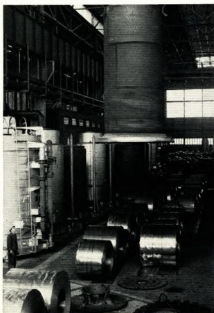
Titelseite: In der erweiterten Haubenglüherei des Kaltwalzwerkes der Westfalenhütte werden die hart gewalzten Stahlbandringe wieder weich und gut verformbar, damit sie allen Kundenwünschen der blechverarbeitenden Industrie entsprechen. Ein Kran hat eben eine Schutzhaube vom Ofensockel abgehoben
