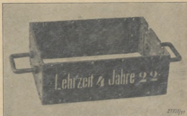
Bild 2: Facharbeit für Bauischlosser: Formlasten (Oberlasten). Ausführung
