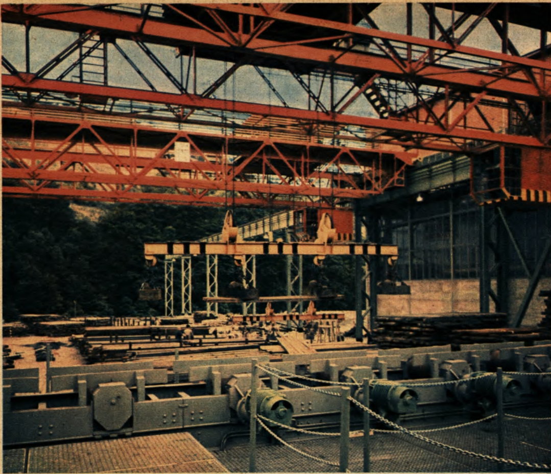
Abb. 11 Das vom Rollgang kommende Halbzeug wird von „Blockdrägen“ zum Ofen transportiert
