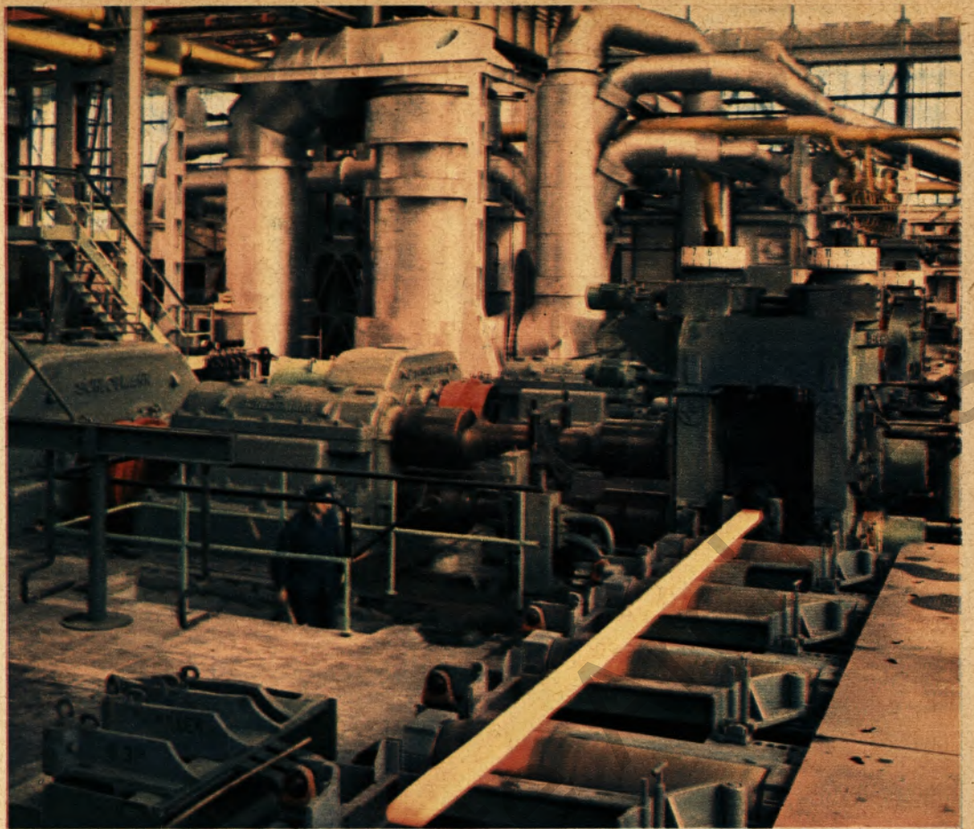
ern" (rechts) in den Ofen eingestoßen Brammen zum Halbzeugrost gebracht, von dem aus sie über den Roll- und ist in den ersten Vorgerüsten der Vorstraße gewalzt worden
