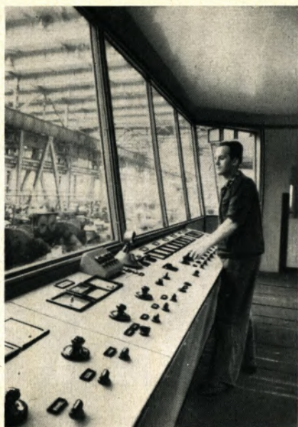
Die Steuerbühne 4 der vollkontinuierlichen Mittelbandstraße in Hohenlimburg wird von Kurt Canavesi bedient.
