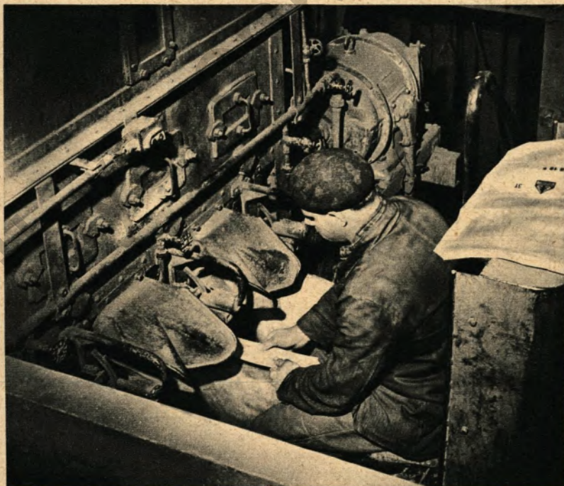
Eine der acht Kugelmühlen, die die Phosphatmühle besitzt. In ihr wird die Schlacke vorgemahlen
