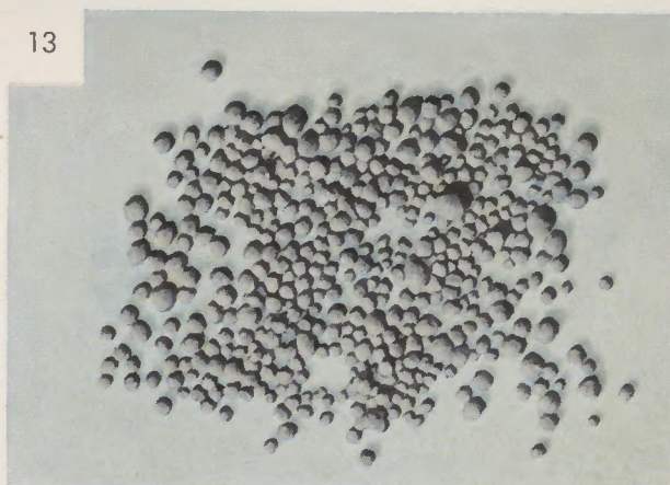
Abb. 13 Suspensions-PVC, Agglomerat für Kabelmassen
