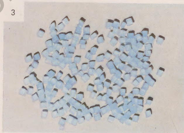
Abb. 3 Polyäthylen-Granulat, oberflächeneingefärbt, hellblau
