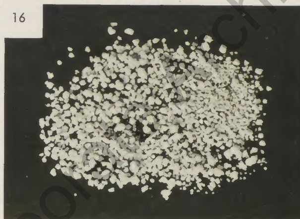
Abb. 16 Suspensions-PVC für Kabelmassen als Agglomerat
