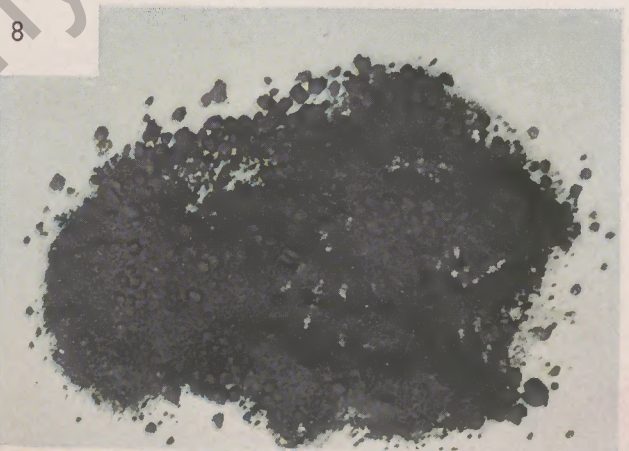
Abb. 8 Polyäthylen, mit Ruß eingefärbt, verdichtet
