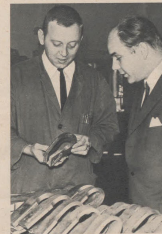
▲ Zu den vielen Kontrollen, denen Schiffsbleche unterworfen werden, gehört auch die mit dem Ultraschallprüfgerät, das etwaige Fehler durch Schlackeneinflüsse aufdeckt; auf unserem Bild prüft Kurt Gryska
