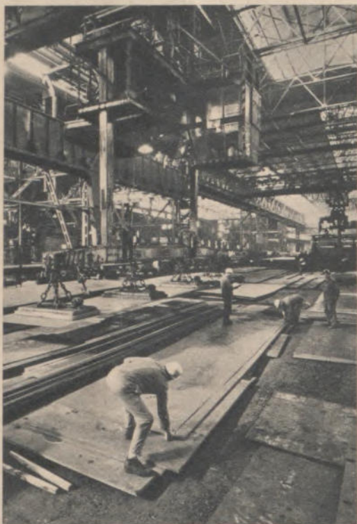
▲ Sind alle Hürden genommen, werden die Bleche unter den Augen des Revisors von einem Magnetkran auf Waggons verladen; von links nach rechts: Helmut Krems, Paul Classen und Revisor Franz Senf
