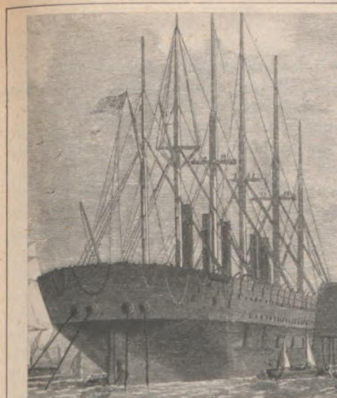
Das erste große Stahlschiff, die „Great Eastern“, wurde schon 1858 erbaut. Dieses Schiff war ganz aus Stahl, besaß neben dem gewaltigen Schaufelradantrieb sechs Masten zum Segeln und konnte 4000 Passagiere aufnehmen
