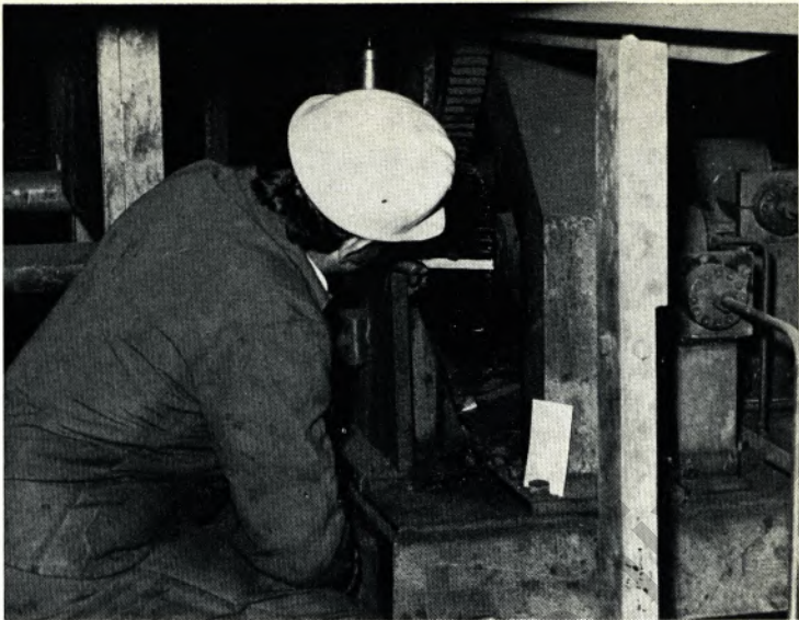
Inspektion einer Fertigungsanlage. Mitarbeiter Josef Koch überprüft den Zahnflankenverschleiß.
