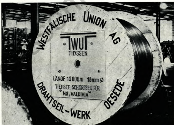
Das versandbereite Seil ist auf einer Holztrommel aufgewickelt und gegen Feuchtigkeit mit Kunststoff-Folie abgedeckt.
