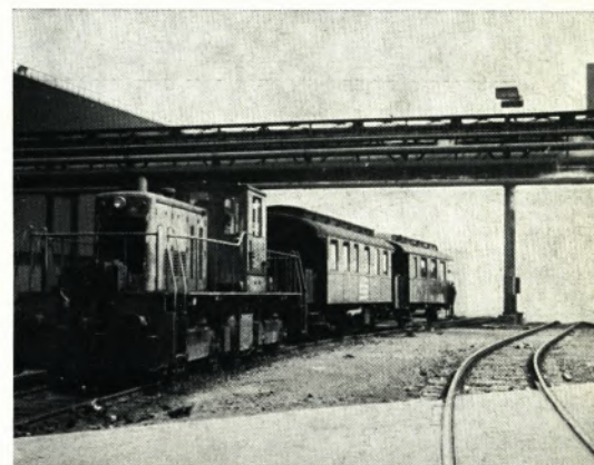
Hinein in die Schwaden der Schlackenbeete im Bereich des Oxygenstahlwerkes Bruckhausen. Bei gedrückter Fahrt steht der Lokführer auf dem Trittbrett des ersten Wagens und kann so den Fahrweg wesentlich besser einsehen.
