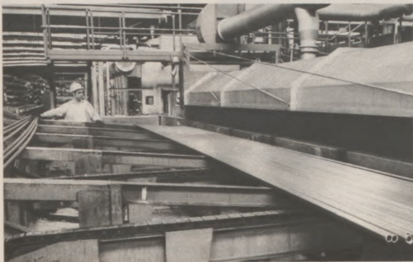
▼ Winfried Brosig von der Glüherei beschickt einen Durchlaufglühofen
