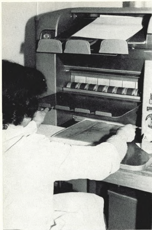
Größere Mengen von Abzügen können von transparenten Vorlagen in Größen bis DIN A 3 von Frau Liesel Schaumlöffel mit diesem Gerät hergestellt werden. Es arbeitet nach einem Lichtpausverfahren und schafft bis zu 400 Vervielfältigungen in einer Stunde
