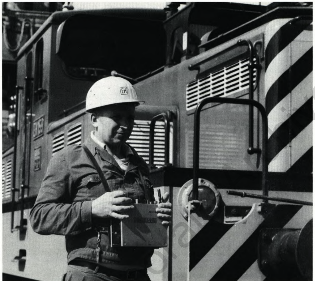
Das Steuergerät für die große Lokomotive hat das Format eines Kofferradios und ist ebenso einfach zu bedienen.
