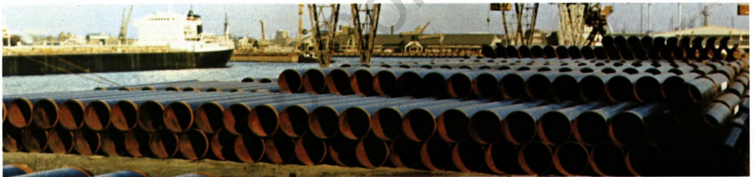
Fertigprodukte: Am Ende der Warmbreitbandstraße wird das Blech zu schweren Rollen aufgerollt und versandfertig gemacht (Bild unten). Aus solchem Blech lassen sich auch spiralschweißte Rohre (Bild oben) herstellen.
