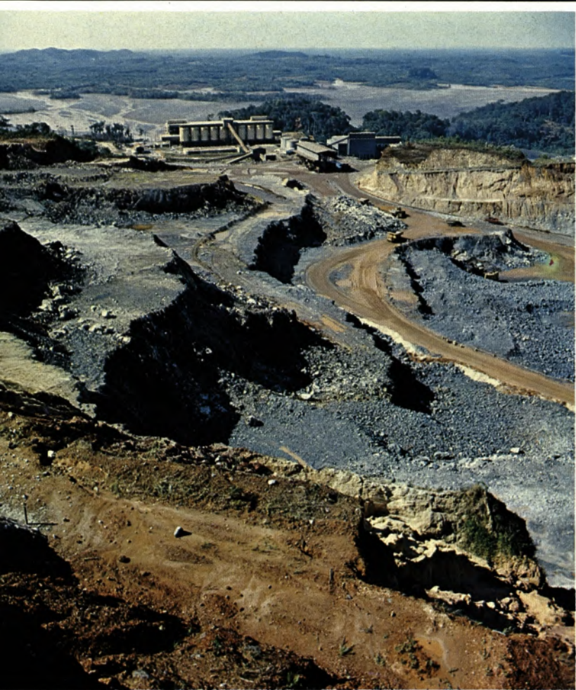
Ein Teil des Erztagebaus der Bong Mining Company mit den Anlagen für die Konzentration und Pelletisierung des Erzes im Hintergrund des Bildes. Dort wird jetzt ausgebaut.
