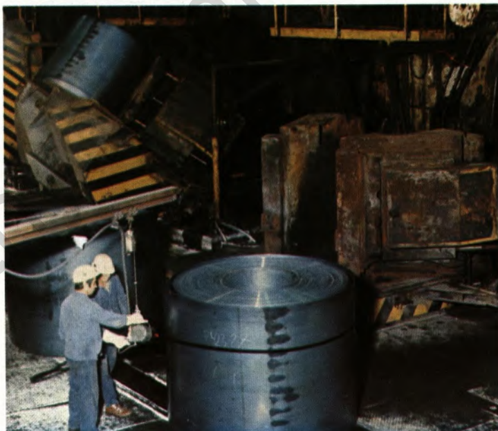
Fertigprodukte: Am Ende der Warmbreitbandstraße wird das Blech zu schweren Rollen aufgerollt und versandfertig gemacht (Bild unten). Aus solchem Blech lassen sich auch spiralschweißte Rohre (Bild oben) herstellen.
