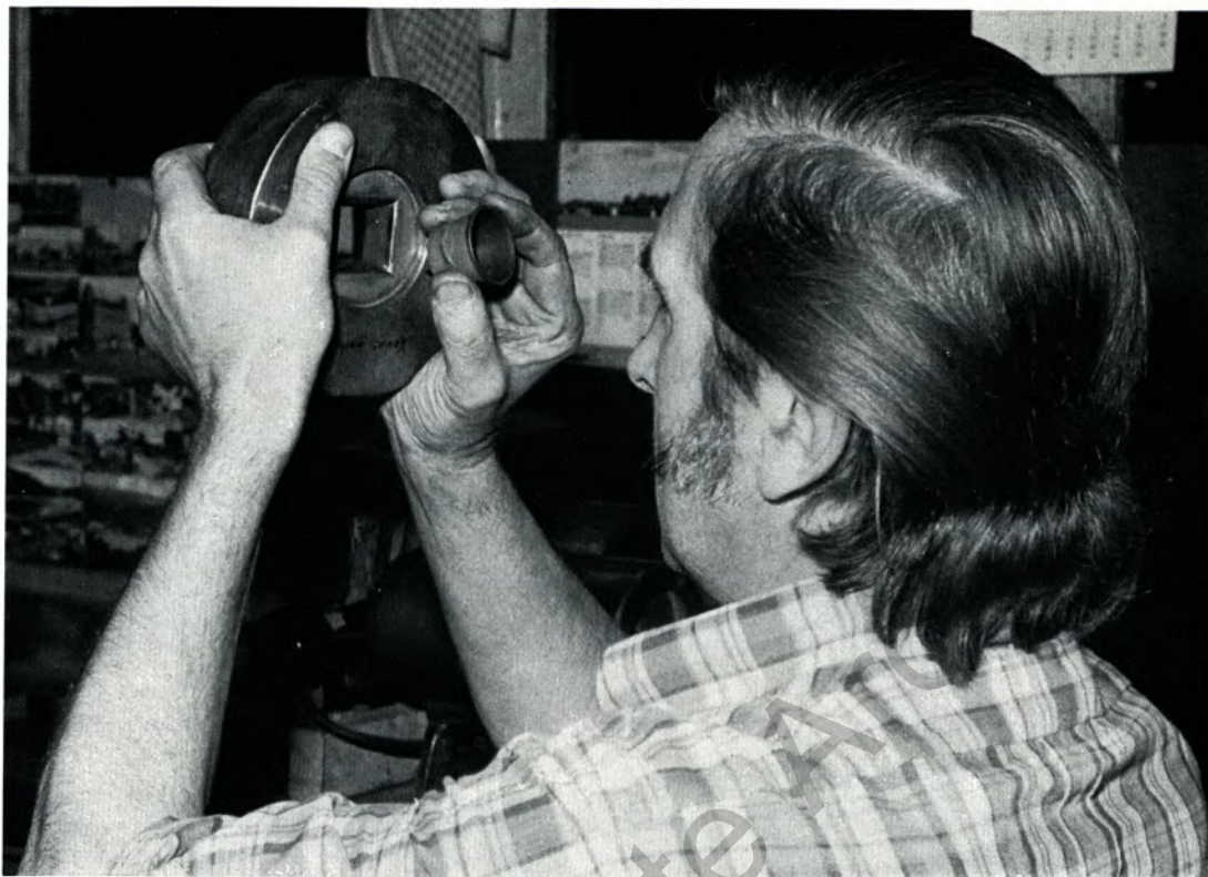
Profilsteinpolierer Egon Libuschewski prüft die Ausbildung des Ziehholes mit der Lupe.
