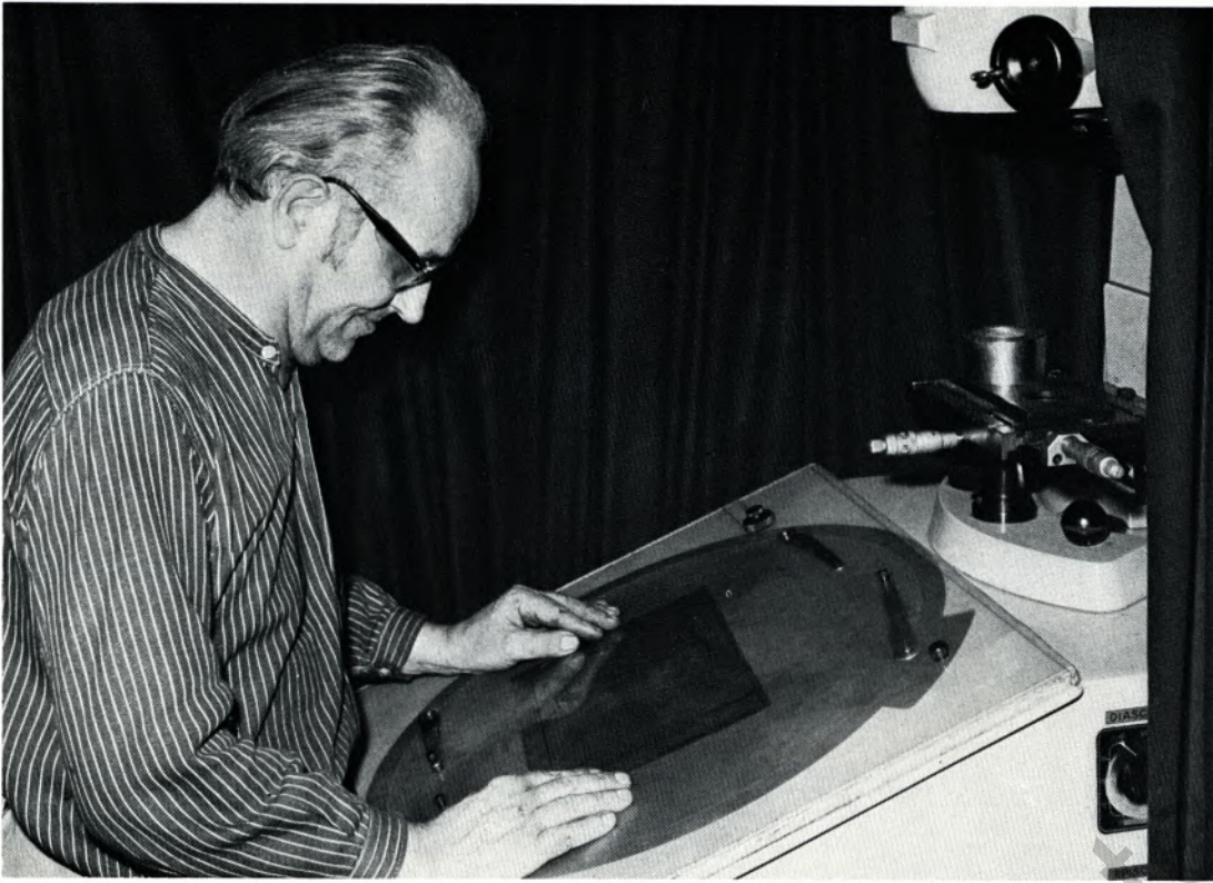
Profilsteinpolierer Otto Milark überprüft an einem Durchleuchtungsgerät die Profiltreue eines fertigen Ziehsteines.
