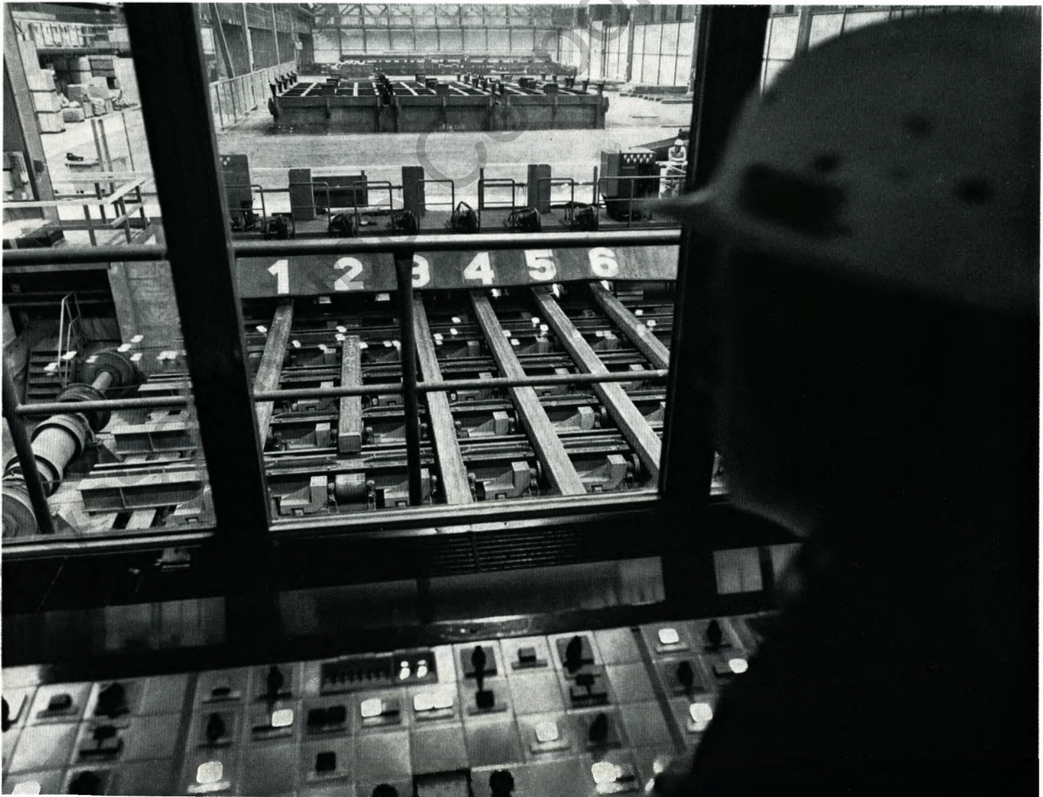
Blick aus dem Brennschneid-Steuerstand auf die sechs Probestrenschneid- und Stempelmaschinen. Im Hintergrund die Adjustage und die Verladehalle.
