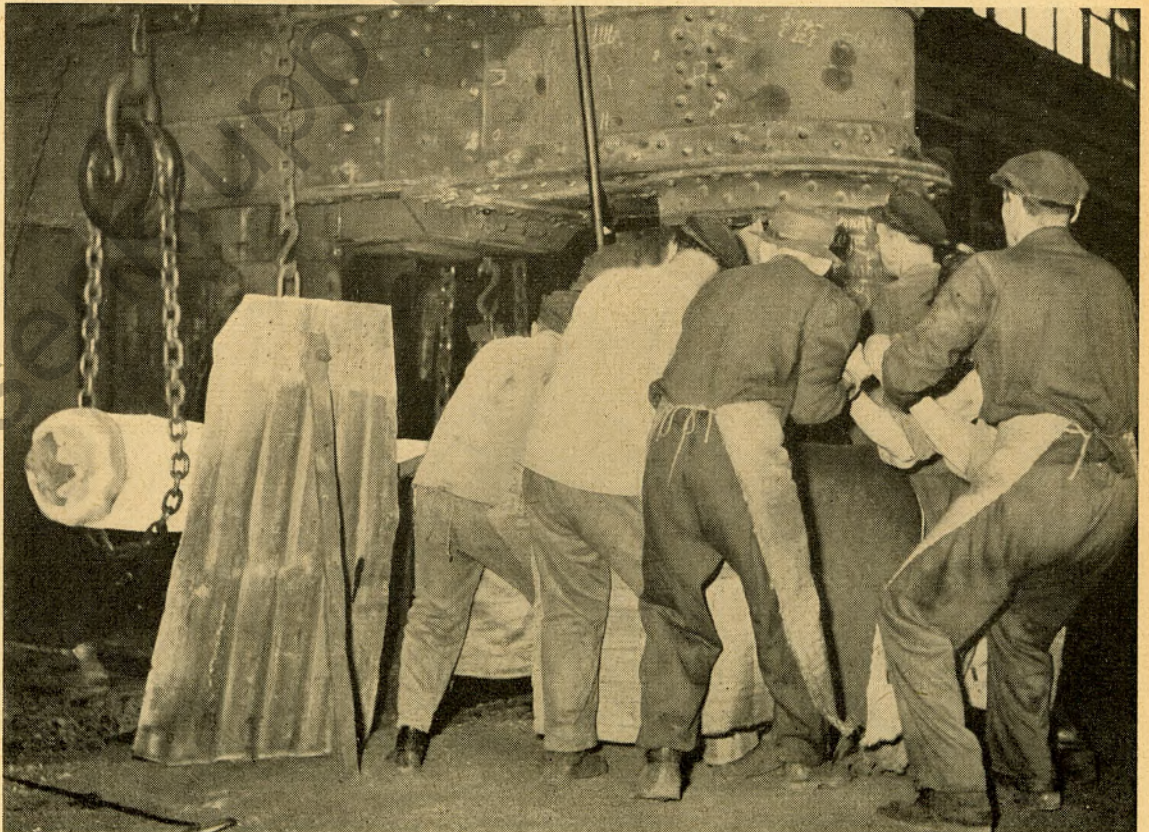
Im Hammerwerk wird eine Welle geschmiedet
