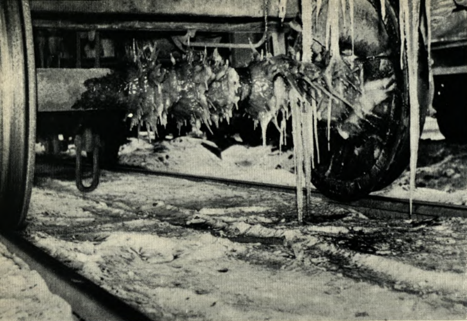
So sieht das Untergestell eines Waggon aus, der bei starkem Frost mit wasserhaltigem Ladegut beladen wird. Falls er nicht umgehend entladen werden kann, muß er mit hohem Kostenaufwand leergemacht werden oder, wie hier, bis zum Eintritt wärmerer Witterung abgestellt werden. Von den verladenden Betrieben wird dieses oft leider noch nicht bedacht.
