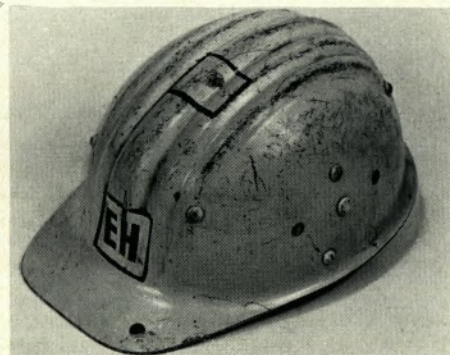
Diesen Helm trug Kolonnenführer W. In dem gekennzeichneten Feld erkennt man deutlich das Loch in der Helmschale.
