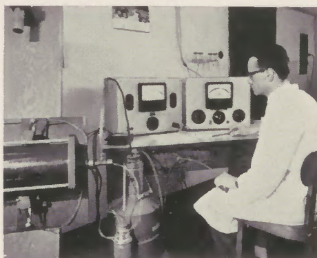
Physikassistentin Ingeborg Bischoff bei der Bestimmung der magnetischen Alterung unserer Dauermagnete. Mit der abgebildeten Apparatur ist es möglich, die winzig kleine Abnahme des Magnetismus im Laufe der Zeit bei Dauermagneten zu beobachten. Diese Messungen bilden die Grundlage für die Entwicklung neuer Dauermagnete, welche ihren Magnetismus unter normalen Bedingungen praktisch nicht mehr verlieren.
