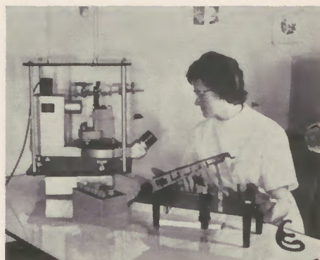
Physikassistentin Ingeborg Bischoff bei der Bestimmung der magnetischen Alterung unserer Dauermagnete. Mit der abgebildeten Apparatur ist es möglich, die winzig kleine Abnahme des Magnetismus im Laufe der Zeit bei Dauermagneten zu beobachten. Diese Messungen bilden die Grundlage für die Entwicklung neuer Dauermagnete, welche ihren Magnetismus unter normalen Bedingungen praktisch nicht mehr verlieren.
