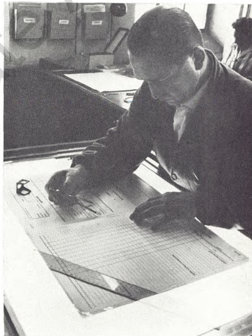
Oben: An einem von unten beleuchteten Montiertisch (rechts) werden von Montierer Schwarz die Vorlagen für die Herstellung der Offsetplatte zusammengestellt. Nachdem der Kopierer und Fotograf Halfmann die Vorlage für den Offsetdruck reproduziert hat, belichtet er die Offsetplatte (links) im Kopierrahmen — Unten rechts: Mit ruhiger Hand führt Frl. Rauh den Pinsel über eine Offsetplatte, die gerade abgedeckt wird. Entwickelt, kann sie dann bald zum Druck benutzt werden
