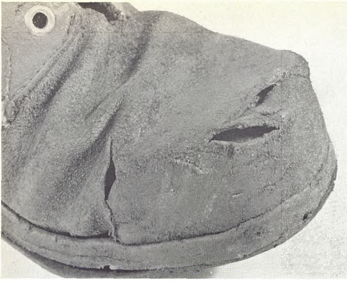
Beachtung der Unfallschutz-Vorschriften macht sich bei Unfällen immer bezahlt: Die oberen Bilder sowie das Foto auf der vorhergehenden Seite zeigen Fußunfälle, bei denen durch Tragen von Sicherheitsschuhen schwere Verletzungen vermieden wurden
