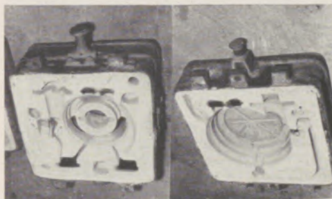
Offene Form: Ober- und Unterkasten
