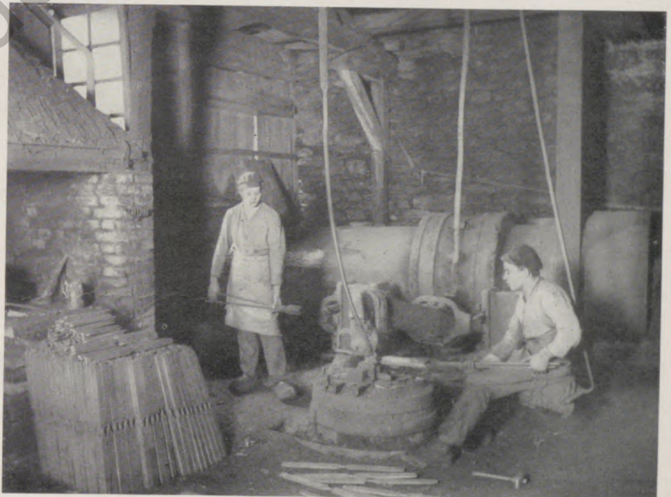
Bild 2: Wasserhammer; das Aus Schmieden der Feilenstähle
