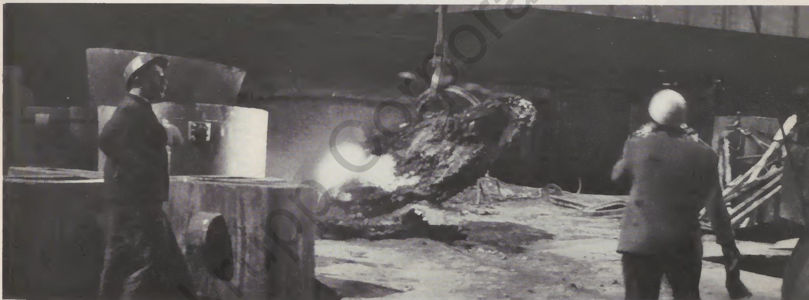
Schlackengrube im Stahlwerk (seit 1961): Saubere und zudem unfallsichere Schlackenbeseitigung in Großkübeln mit Schwerst-Lkw ▼
