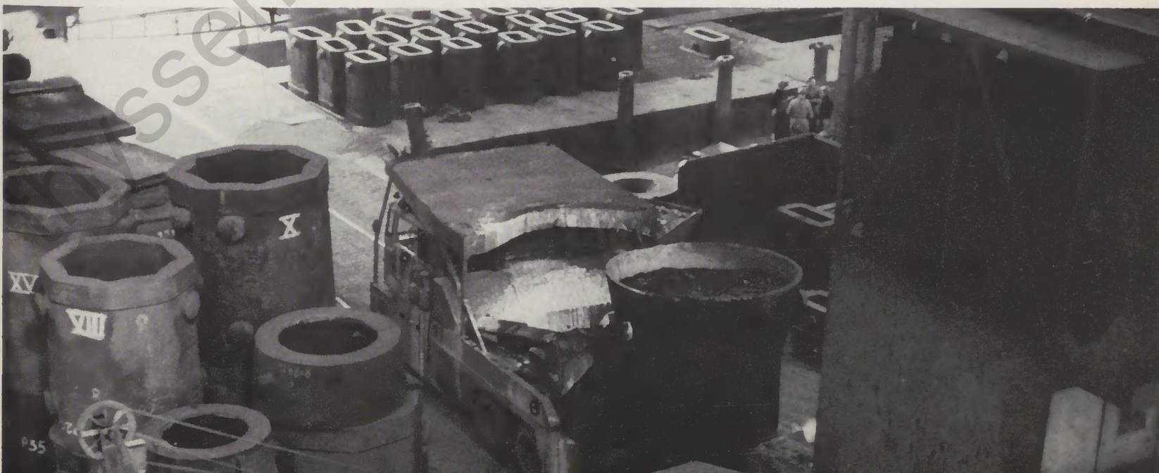
Schlackengrube im Stahlwerk (seit 1961): Saubere und zudem unfallsichere Schlackenbeseitigung in Großkübeln mit Schwerst-Lkw ▼
