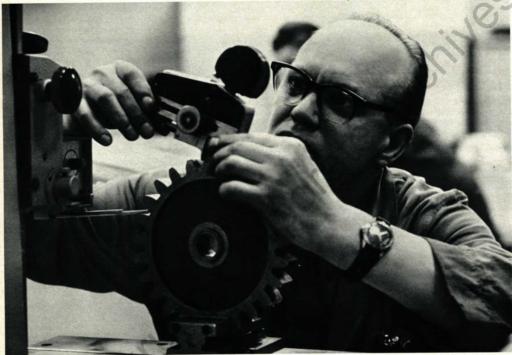
▲ Revisor Ewald Varus kontrolliert im Meßraum der Maschinenfabrik Deutschland an einem Zahnrad die Eingriffsteilung und mißt die Rauhtiefe
