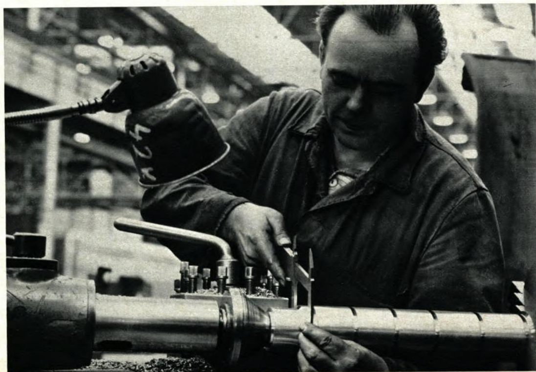
► In der mechanischen Werkstatt der Westfalenhütte mißt Dreher Udo Bachner Büchsen für Stückrollen der Mitteleisenstraße
