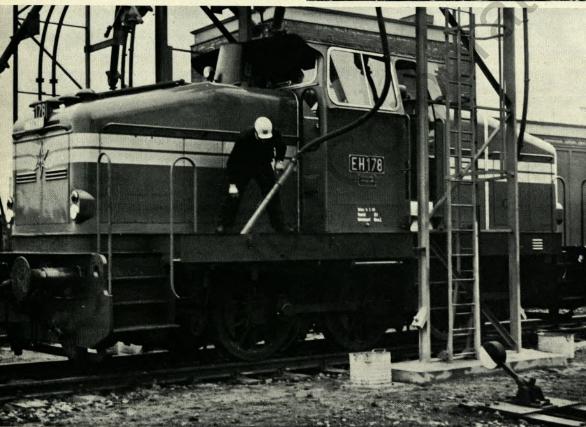
Hier wird eine Diesellok an der neuen Anlage besandet.
