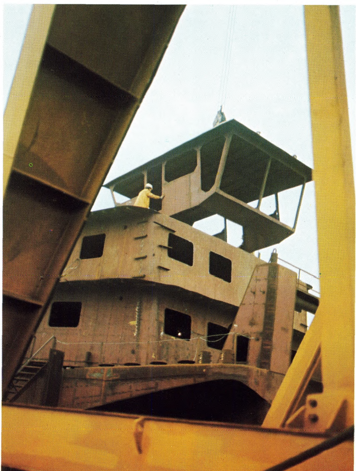
Mit einem sogenannten „Fischauge“ wurde das obere Bild gemacht. Es zeigt die Bodenplatten und Spanten auf der Helling. — Dieser Platz im Schubboot (unteres Foto) wird die drei Dieselmotoren aufnehmen. — Bild rechts: Das Ruderhaus wird aufgesetzt.
