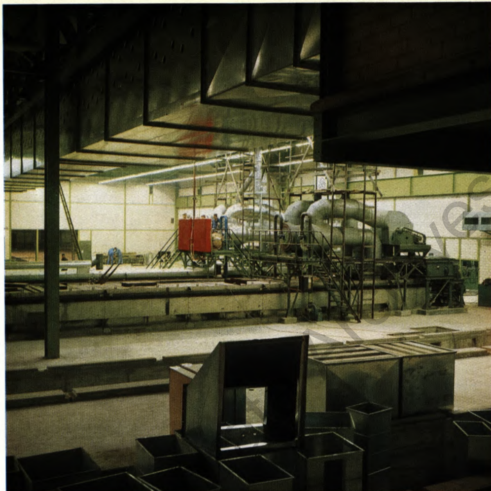
Bild oben: In 35 Meter langen, gasgefeuerten Trockenöfen werden die preßfrischen Elektroden getrocknet. Bild unten: In laufenden Stichproben werden die aus der Presse kommenden Elektroden vor Einlauf in den Trockenofen auf Maßgenauigkeit und Zentrizität des Kerndrahtes zur Umhüllungsmasse geprüft.
