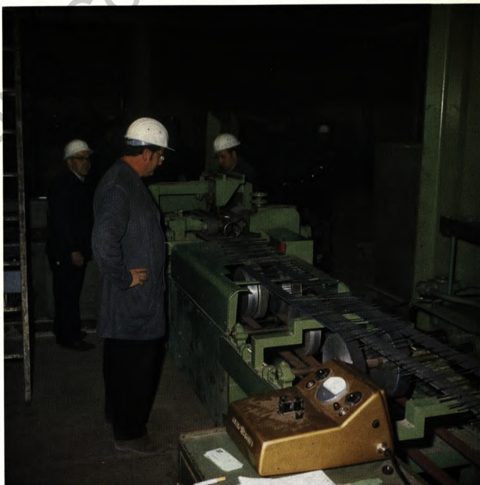
Bild oben: In 35 Meter langen, gasgefeuerten Trockenöfen werden die preßfrischen Elektroden getrocknet. Bild unten: In laufenden Stichproben werden die aus der Presse kommenden Elektroden vor Einlauf in den Trockenofen auf Maßgenauigkeit und Zentrizität des Kerndrahtes zur Umhüllungsmasse geprüft.
