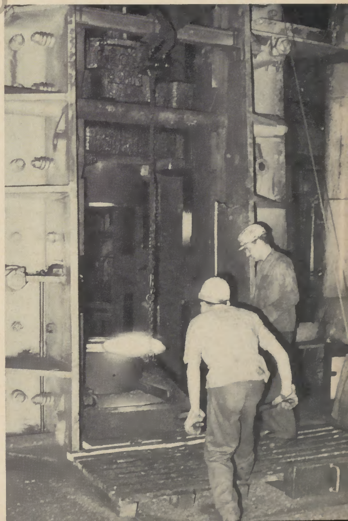
Automatisches Abgreifen eines schweren Flansches aus der Bohrstation
