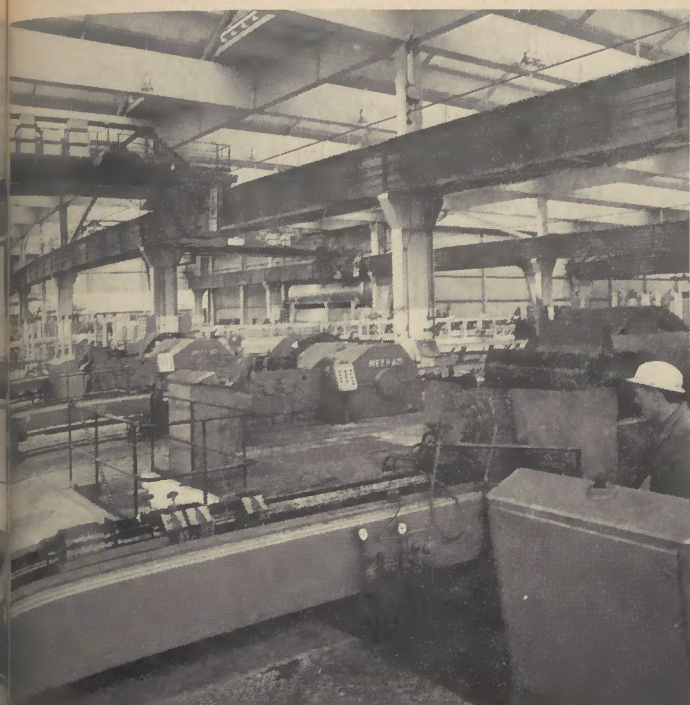
Kaltpilgeranlage zur Fertigbearbeitung von nahtlosen Stahlrohren im Edelstahlrohr-Betrieb
