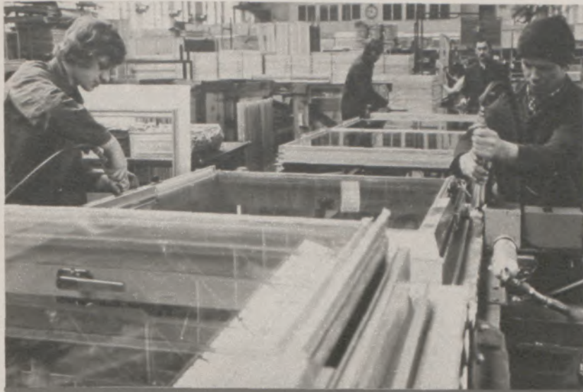
Arif Gümüs und Wolfgang Kunisch fügen den Fensterkasten mit dem verglasten Schwingflügel zusammen, verbohren und verschrauben ihn
