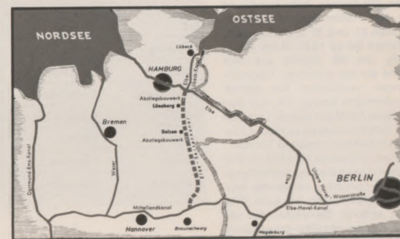
▲ Der im Bau befindliche Elbe-Seitenkanal wird das westdeutsche Industriegebiet mit Hamburg verbinden. Er hat auf 115 Kilometer Länge einen Höhenunterschied von 61 Metern zu überwinden
