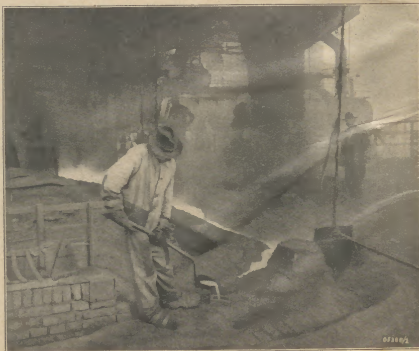
Beim Abstich — Der Schmelzer nimmt eine Eisenprobe
