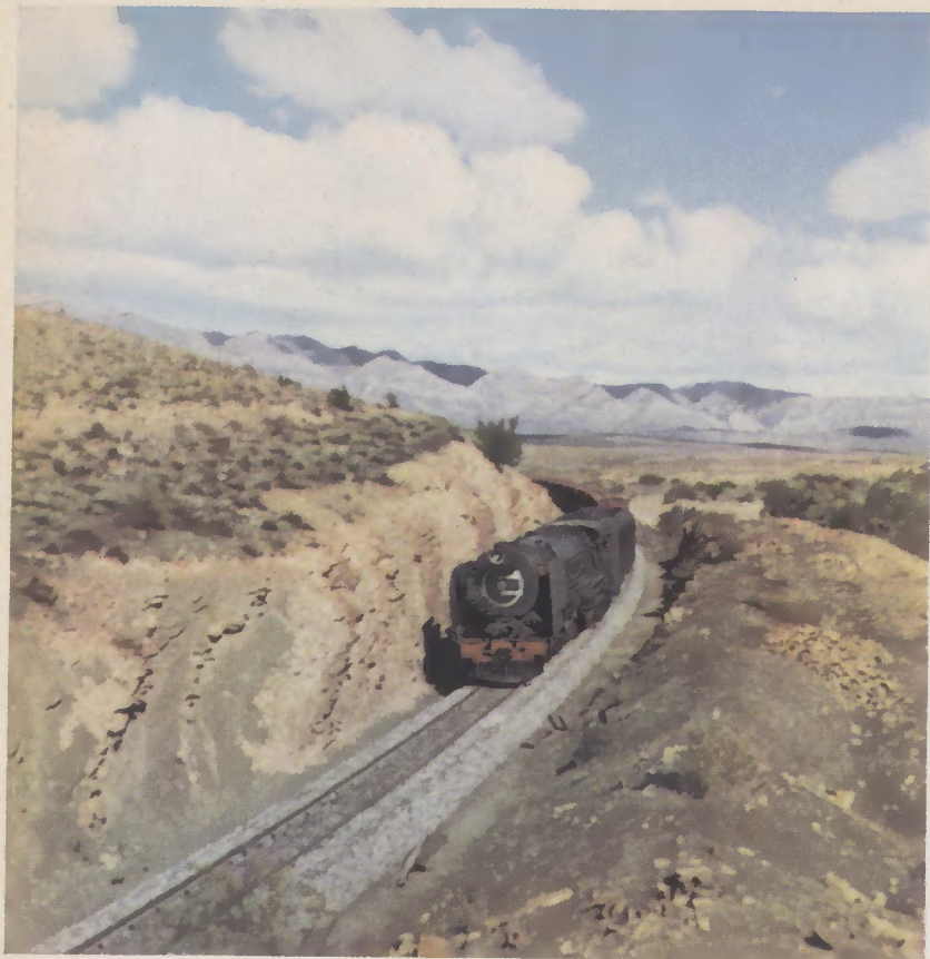
Henschel-Kondens-Lokomotive Class 25 NC der Südafrikanischen Staatsbahnen auf der Strecke Touwsriver-Skeiding
