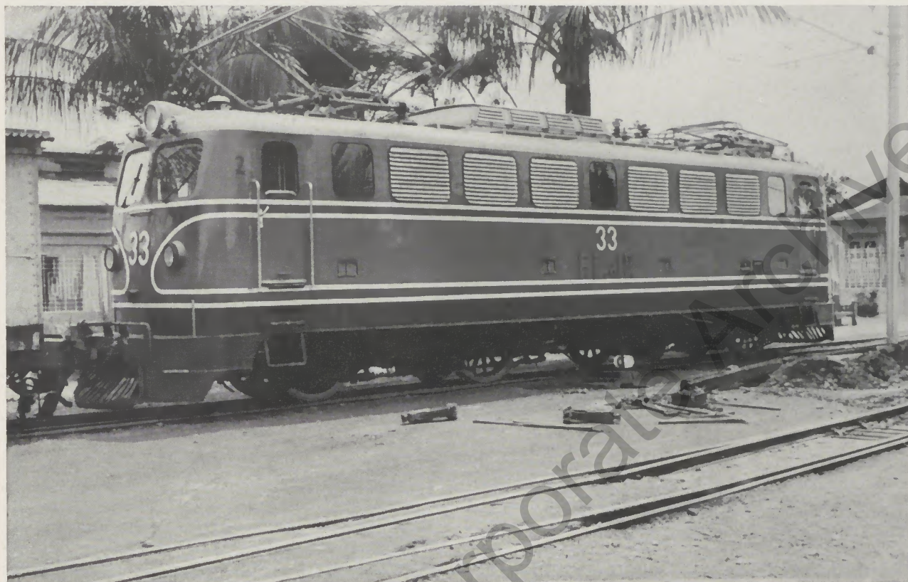
Abb. 1 Elektrische Henschel Bo'Bo' Lokomotive, eingesetzt in Costa Rica bei F. E. al P. (Ferrocarril Eléctrico al Pacífico)
