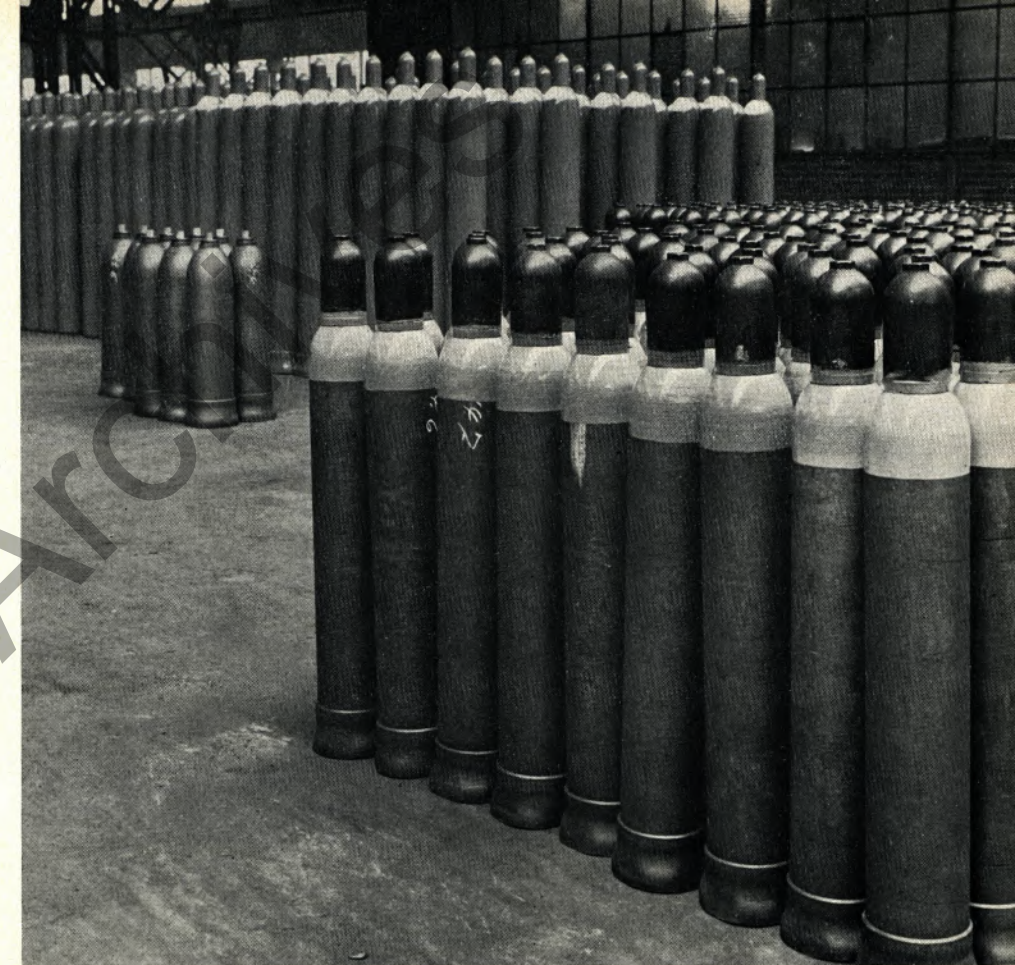
Stahlflaschen und -behälter in allen Größen, von 0,4 bis 600 Liter Inhalt, können im Werk Dinslaken hergestellt werden. Rund 30 Typen gibt es, die aus sieben verschiedenen Werkstoffen gefertigt sind
