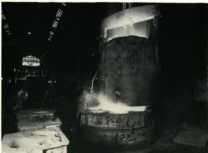
Stahlformguß in Linden. Sprühend fließt der weißglühende Stahl in die vorbereiteten Formen
