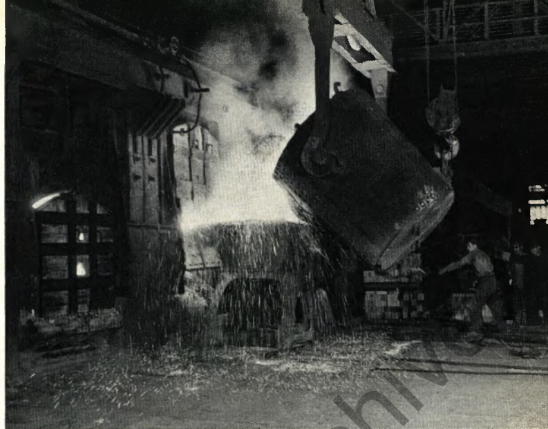
Zunächst wird der Ofen mit Schrott chargiert, dann gibt man flüssiges Stahleisen zu
