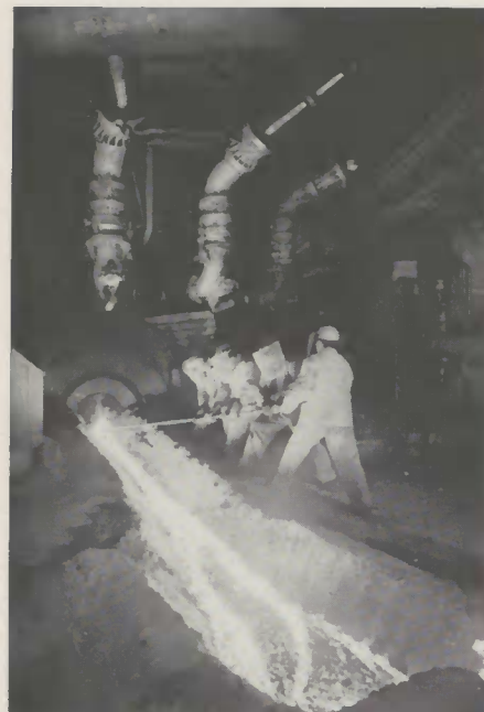
Titelseite: Erster Abstich am neuzugestellten Hochofen 6: die Ofenmannschaft stößt das Abstichloch frei, das Eisen beginnt zu laufen, und die zweite Ofenreise – zu der wir viel Glück wünschen! – hat begonnen.
