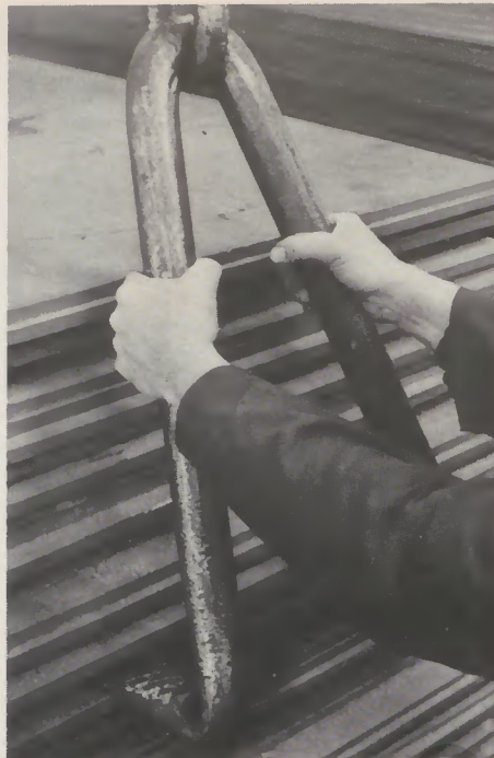
Anhänger: Transporthaken, Ketten und Seile beim Anhängen nie umfassen, Quetschungen! (oben: falsch; links: richtig)
