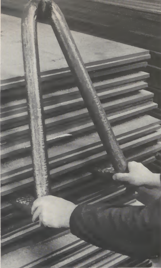
Anhänger: Transporthaken, Ketten und Seile beim Anhängen nie umfassen, Quetschungen! (oben: falsch; links: richtig)
